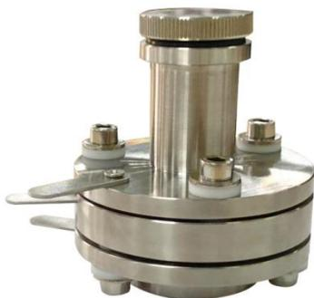
EQ-3ESTC15 是一款可拆卸式三极电池测量装置，专门针对于可充电电池材料的探索和研发。此款设备为用户提供一种结构来模拟组装的扣式电池，可以充分方便的将电池装配好，对电极进行各种测试。此款设备可分为三个部分，上下两部分是连接阴极和阳极片，而中间部分是连接参比电极，用于检测两极额变化。
