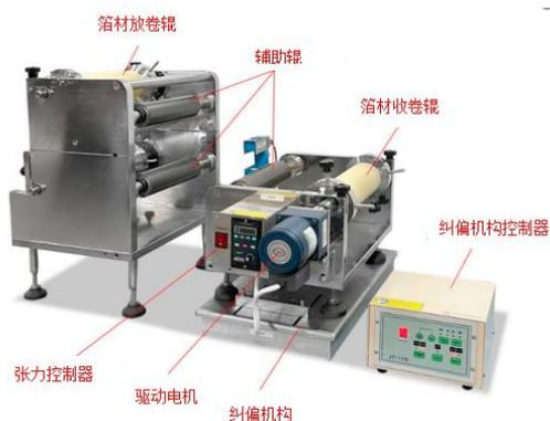
MSK-RR-LA 是一款自动卷对卷机构，设计用于将 2 种箔材通过热轧机层压复合。
